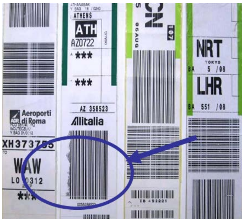
Figura 7 - Tag Pinter con testina sporca o Failed dots
