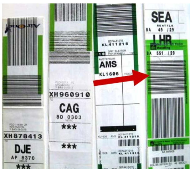
Figura 8 - Codice a barre tra le bande verdi per uso di carta non compatibile col settaggio della tag printer
